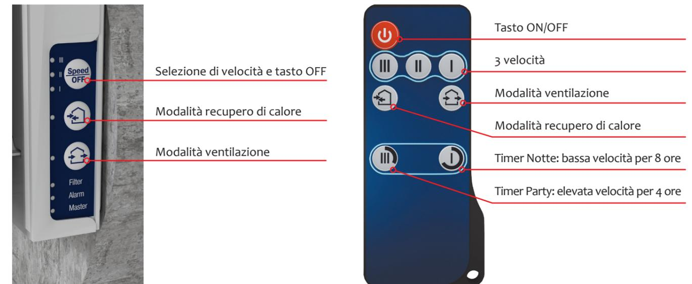
L'unità di ventilazione è munita di un sensore di umidità per il controllo dell'aria nel locale. Il collegamento in serie di più unità assicura una ventilazione controllata dei locali. La prima unità della serie diventa l'unità master. Il funzionamento dell'intero sistema viene comandato tramite la regolazione dell'unità master. I segnali del telecomando vengono recepiti soltanto dall'unità master.
